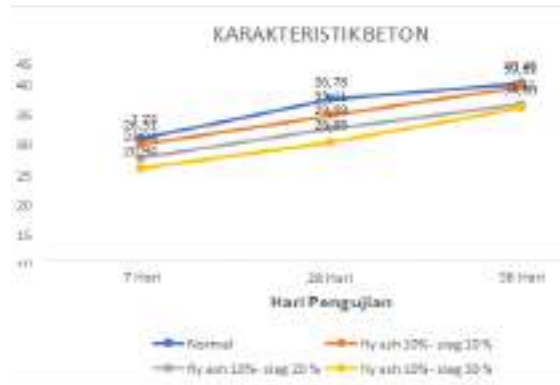
Gambar 3 Hasil Uji Kuat Tekan Beton
